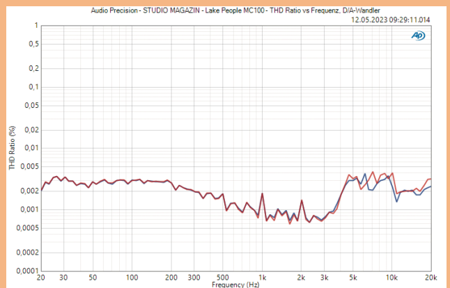
Diagramm 12: D/A-Wandler – THD Ratio über die Frequenz bei -1 dB
