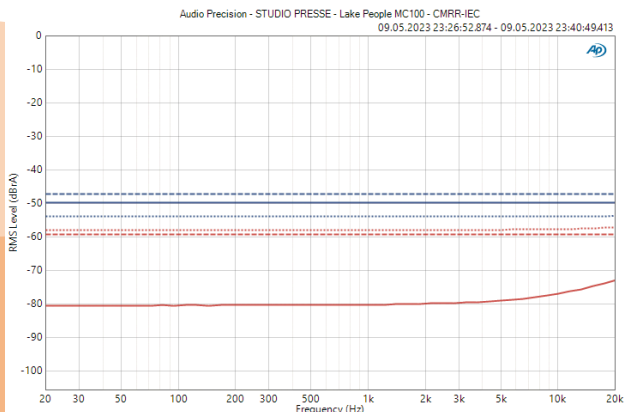
Diagramm 5: Analogeingang – Gleichtaktunterdrückung CMRR nach IEC, höchste Messung bestimmt das Ergebnis
